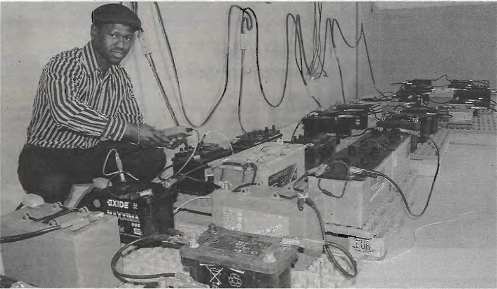
Le système Phoenix permet à Seydina Diedhiou de régénérer jusqu'à 20 batteries en même temps.
